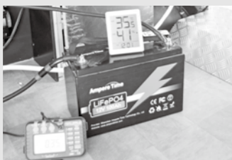
リーズナブルな100Ahのリチウムイ オンバッテリーを電源にして電流量を測 定。車内外、吹き出し口温度も計測。
