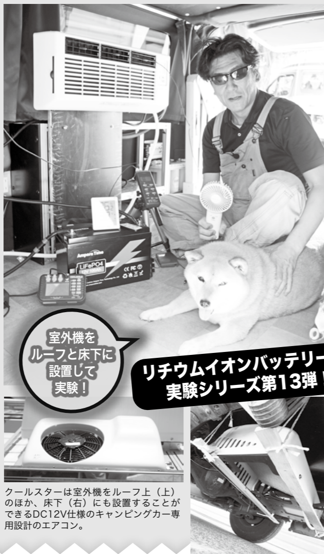
リーズナブルな100Ahのリチウムイ オンバッテリーを電源にして電流量を測 定。車内外、吹き出し口温度も計測。
