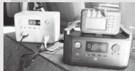
↑エコフロー・リバー600に折り畳み式ソーラーパネル（120W）を繋いで充電し、同じエコフローにAC100V充電してエアコンを動かす。 ↓ソーラー充電中のエコフローからブルティEB3AにAC100V給電してエアコンを動かす。
