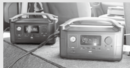
↑エコフロー・リバー600に折り畳み式ソーラーパネル（120W）を繋いで充電し、同じエコフローにAC100V充電してエアコンを動かす。 ↓ソーラー充電中のエコフローからブルティEB3AにAC100V給電してエアコンを動かす。
