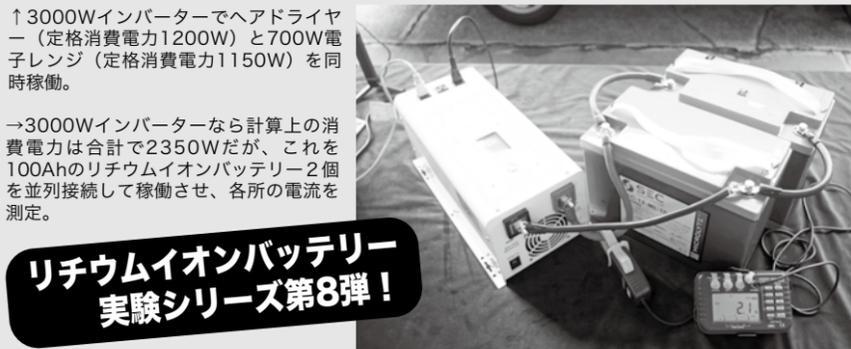
↑3000Wインバーターでヘアドライヤー（定格消費電力1200W）と700W電子レンジ（定格消費電力1150W）を同時稼働。
