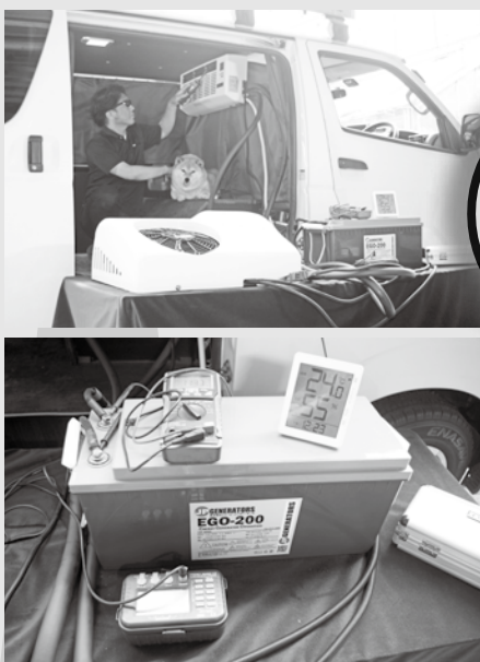
外気温30℃オーバーの環境下で、ハイエースの居住スペースにクールスターの室内機を装着し、車外のテーブル上に室外機を置き、DC12Vで容量200Ahのリチウムイオンバッテリーのみで稼働時間と車内冷却温度、消費電流などを測定。
