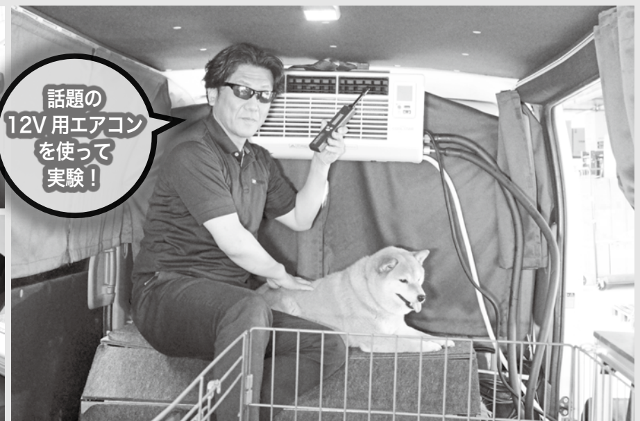
外気温30℃オーバーの環境下で、ハイエースの居住スペースにクールスターの室内機を装着し、車外のテーブル上に室外機を置き、DC12Vで容量200Ahのリチウムイオンバッテリーのみで稼働時間と車内冷却温度、消費電流などを測定。
