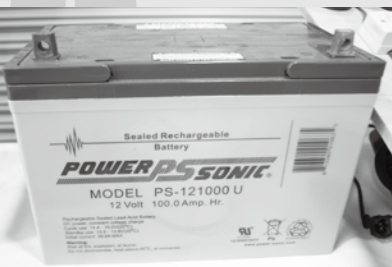
実験で使用した鉛のディーブサイクルバッテリーは、定評のあるパワーソニックのPS-121000（100Ah）。
