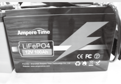
並列接続したリチウムイオンバッテリーは、前回使用したアンペアタイム（リン酸鉄/100Ah）で、容量はパワーソニックと同じ。
