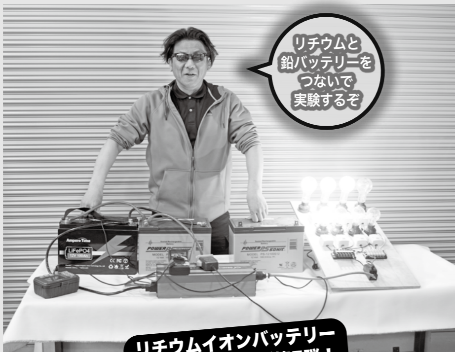
実験前のリチウムイオンバッテリーの電圧は13・23Vで、鉛バッテリーよりも低いが高電力には強い。
