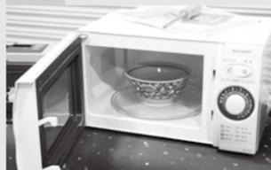
←600W電子レンジ（電力使用量960W）に水を入れた丼をセットし、5分間の温めを何回できるかを計測。気温が低いので手早く実証実験を行わないと、丼内の水が凍りつく恐れあり。→同じインバーター（1500W）を介して廉価なBMS付きリチウムイオンバッテリー（100Ah）と、信頼性の高いスーパーB（90Ah）で、それぞれ何回温められるか実験。電子レンジ停止の端数は秒単位で計測。
