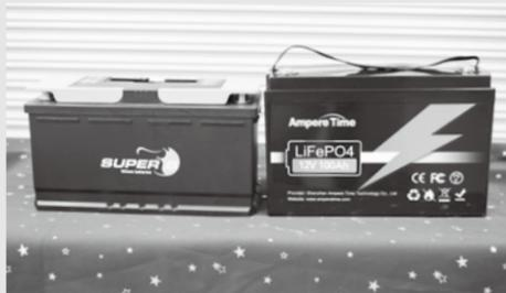
↑左が信頼できるリチウムイオンバッテリーのスーパーB（90Ah）だが、価格は300,000円弱。右はネット通販で50,000円弱で購入したアンペアタイム（100Ah）。廉価だが各国の製品規格をクリアしたマークがあり、BMSの構造も図説されていた。
