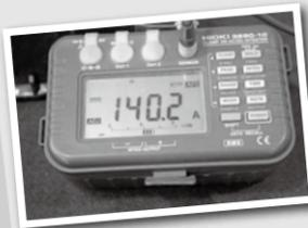
←今回の実験で使用した500Wの家庭用電子レンジは、定格消費電力が960W。だが、電子レンジの種類によっては12Vラインに140Aの大電流が流れたので、1600W以上の大電力が流れるものもある。→比較実験で使ったスーパーBは、容量90Ahの最新型で市価は充電コントローラー込みで300,000円前後。
