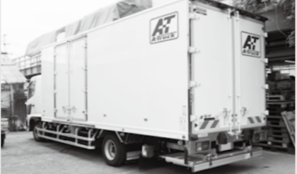
↑今回の実験では冷凍マグロなどを運ぶ冷凍コンテナ車を使用。-30℃まで冷やせる本格仕様。
