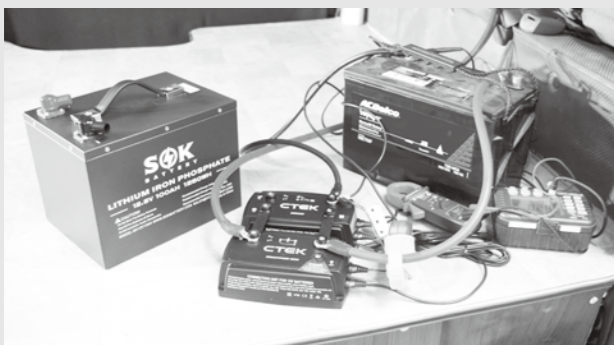
鉛バッテリー (ACデルコ M27MF/105Ah) と、ほぼ同容量のリチウムイオンバッテリー (SOK/100Ah) での充電時間を、走行充電器シーテックを使って比較。
