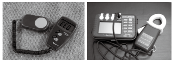
実験は配線を通る電流を計測できるクリップ式電流計（右）と、高精度の照度計（左）を使用して正確に測定。だが今回は、日陰での性能の違いが予想を下回る結果になってしまった。
