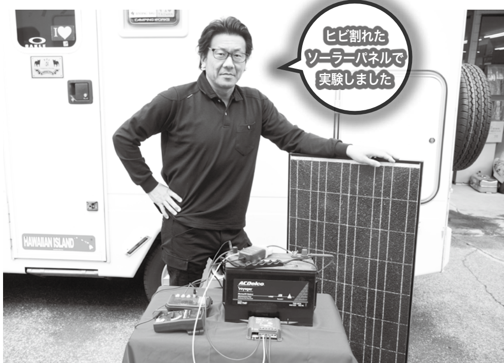
実験で使用したソーラーパネルは、一見すると破損していないが、表面の強化ガラスをよく見るとヒビ割れが縦横無尽にあり、雨にさらされると浸水する。
