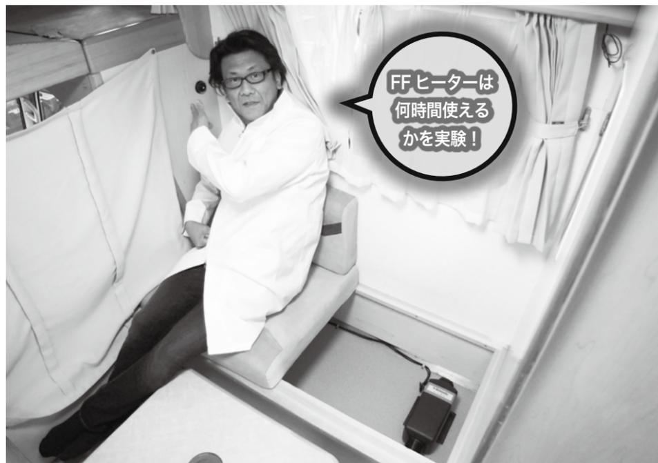
コンパクトキャブコンを想定して「アミティRR」のダイネットソファ内に設置したベバスタの「エアトップ2000ST」（標準的な暖房能力2000Wタイプ）を使い、窓を全開状態でフル稼働を維持するように設定。燃焼継続時間を実証実験してみた。
