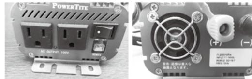
シガーソケットにつなぐインバーターは正弦波の出力500Wタイプ。使用電力が500W近くになると警告音が鳴り、超えると停止。
