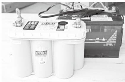
↑ディープサイクルバッテリーのオプティマ・イエロートップD1400SとACデルコM270MF（セミサイクル）を並列接続。↓ACデルコM270MFの並列接続と、電子レンジの大電力を使って実証実験。
