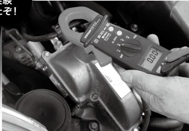
●今回の実験は走行状態の機器による走行充電の電流量の差異を測ること。方法は残量50%のサブバッテリーをリレー式とアイソレーター式で充電。エンジン回転数を2000回転に設定して経過時間でサブバッテリーに流れる電流を測ってみた。
