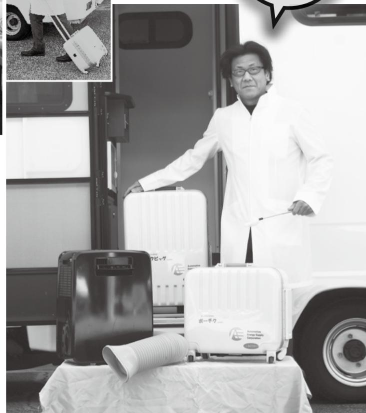
今回の実証実験は、ポーチクでエアコン類をどの程度まで稼働できるのか、バッテリーにとって非常に過酷な実験を行うと共に、一昨年のデュープサイクルバッテリーでのエアコン稼働との比較を行うことにした。比較するに当たって、ポーチクのバッテリー容量をAhに変えなくてはならない。まずは、標準タイプのポーチクは1000Whなので、Ahは1000Wh÷12V（比較するデュープサイクルバッテリーが12Vなので）≒約83Ahとなる。同様に、ポーチクビッグを方程式に当てはめ計算すると約167Ahとなる。この数値を念頭にエアコン類の稼働時間を計測するのだが、標準タイプは合計最大出力が700Wなので、家庭用エアコンの稼働は不可能（起動時に最低でも1000Wが必要）と判断し、標準タイプのインバーターの瞬間最大電力（数十秒だけ）を期待し、最大消費電力800
