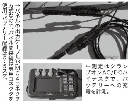
←測定はクランプオンAC/DCハイテスタで、バッテリーへの充電を計測。
