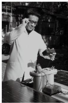
→バッテリーへの電流の測定中は、パネルに影を落とさないように注意。
