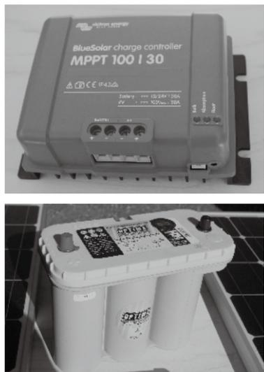
要となるMPPTソーラーチャージコントローラーは、ビクトロンエナジー社製の「ブルーソーラーチャージコントローラー」を使用し、オプティマのディープサイクルバッテリーへ充電。
