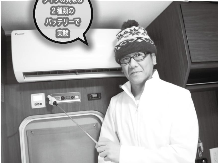
リチウムイオン対応のポトロニックのバッテリー残量計は、瞬時の使用電流も測定できるので、エアコンの暖房状態の設定を30℃にしての電流状態も測定。
