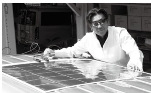
↑炎天下ではソーラーパネルの表面は60℃以上となり、触ると火傷してしまう灼熱状態。↓通常の温度計では測定不能なので、温度測定はレーザー測定式温度計が必需だ。
