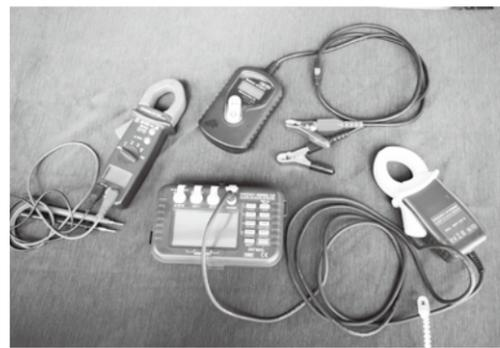
↑実験時の測定にはオプティマのバッテリーアナライザー（中上・CCA測定）や、電流積算測定機能に優れたHIOKIのクランプオン・ハイテスタ（中下・放電容量測定）などを使用。↓実験に使用したバッテリーは、左がACデルコM27MF、右がオプティマD1400SB。
