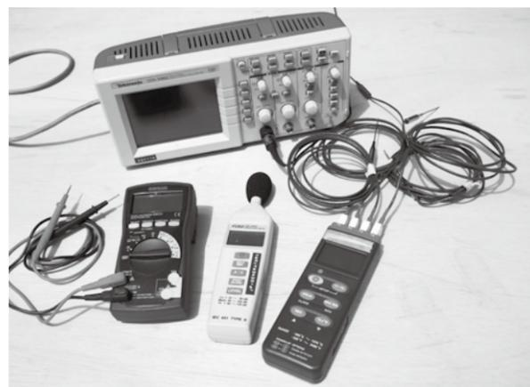
吸排気口それぞれと、エンジン内、本体下付近の4カ所の温度を同時に測定するので、4センサー式の精密電子温度計で測定。無負荷 (エコスロットル) と、負荷1kW (電子レンジ相当) の通常運転で、それぞれ測定した。
