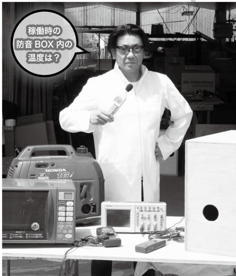
今回は、皆さんがエアコンや電子レンジ使用時によく使っているホンダEU-16iを、DIYで作るタイプの木製防音ボックス (吸排気口側に直径10cm程の穴あり) に入れて、外気中での使用状態との温度変化の差を測定してみた。
