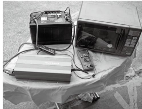
使用2年のサブバッテリー（115Ah）に出力1500Wのインバーターを接続して、スイッチOFFの暗電流とONの待機電流を測定。さらに、インバーターのスイッチON状態で、オープン&グリル機能付き電子レンジを接続しただけの合計待機電流も測定。
