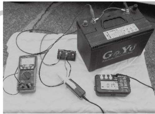
→5年落ちの旧式パネル(左)は180Wタイプで大きく重い。対する新型(右)は150Wタイプだが小さく軽い。この2枚それぞれを同じPWM方式のチャージャーを介して、105Ahのサブバッテリーにどれだけの電気を充電するかを実証実験。すると下の表のように、旧式は開放電圧が高くパネル本体の劣化はなかったが、チャージャーとの相性は悪かったようで充電量が低かった。↓1.テスター。2.クリップメーター。3.ソーラーチャージコントローラー。
