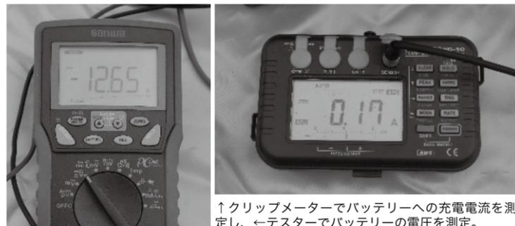
↑クリップメーターでバッテリーへの充電電流を測定し、←テスターでバッテリーの電圧を測定。
