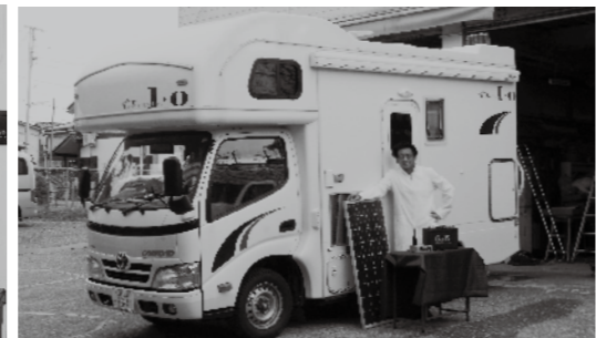
実験は、走行充電からのサブバッテリーへの電気供給ラインとソーラーからの供給ラインで、クリップメーターを使い測定。
