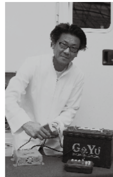
実験は、走行充電からのサブバッテリーへの電気供給ラインとソーラーからの供給ラインで、クリップメーターを使い測定。
