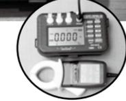
←サブバッテリーの充電の電流値の測定には、サンワのデジタル・マルチメーター(PC720M)を使用。
