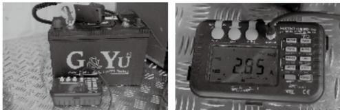
↑消費電流と電圧の測定(左)は、バッテリーから冷蔵庫へ直接電力供給を行う+ラインにクリップメーターを設置。電流量は精度重視の1/100Aで行った。
