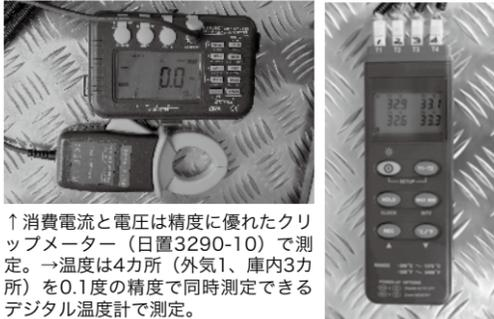
↑消費電流と電圧は精度に優れたクリップメーター(日置3290-10)で測定。→温度は4カ所(外気1、庫内3カ所)を0.1度の精度で同時測定できるデジタル温度計で測定。
