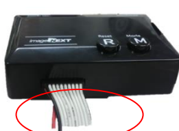
BoxとECUをフレキケーブルで接続してください
