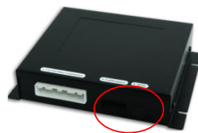
BoxとECUをフレキケーブルで接続してください
