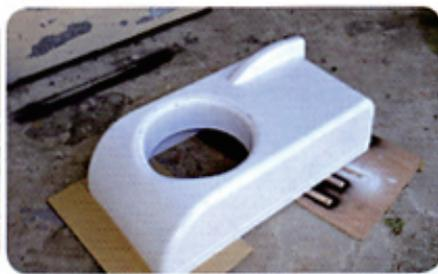
左の写真はFRPのカバーと、新規に製作したフレームに組み替えられていくアルミのフィンやコンプレッサーといった室外機のパーツ。家庭用エアコンの室外機が、キャンピングカーのルーフ上に積載できるスマートな姿に生まれ変わる。この室外機が誕生したことで、幅広いモデルへエアコンの搭載が可能になった。
