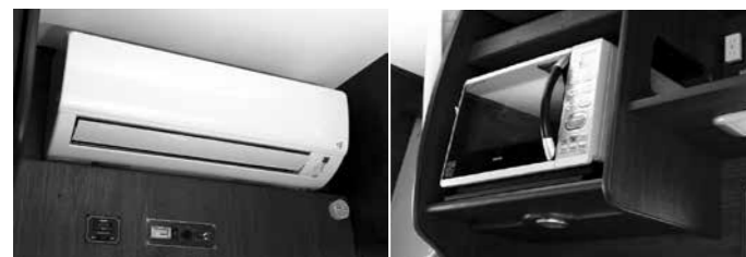
エアコンや電子レンジなど、数百ワットを一気に使う家電の電力はソーラー充電で補うのはまだ難しい。旅行前にはサブバッテリーをしっかりと充電しておこう。
