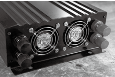
インバーターには冷却用のファンが内蔵されている。定期的な清掃とともに埃がたまりにくい場所に設置するなどの対策も必要となる。
