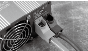
インバーターやバッテリーへの接続も専用の端子が必要となる。写真はパワータイト製インバーターで、緩みにくい設計になっている。
