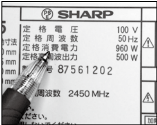
家電の消費電力を調べるには、家電に貼ってある定格消費電力をチェックすること。この数字がインバーター選びの参考になるのだ。
