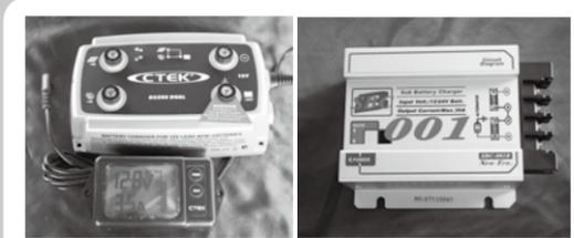
今回、実験したCTEKのベースシステム「D250S DUAL」(左)は、最大20Aの充電能力があり、単独でソーラー発電にも対応。比較実験で使用したニューエラー「SBC001B」(右)は、最大30Aの充電能力がある高性能タイプ。
