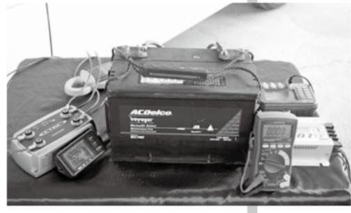
実証実験では、メインバッテリー（オルタネーターからの電力供給）の電圧とサブバッテリーへの電圧、電流量に加え、CTEKは充電器本体からの供給電圧も測定してみた。
