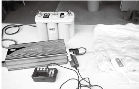
大電流供給に優れたオプティマ・イエロートップのディープサイクルバッテリーに最新型インバーターのJPG1500をつなぎ、出力コンセントに分割クランプセンサーを介して測定品のコンセントを接続。
