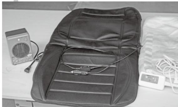
実際の電流量を測定したのは、左からセラミックヒーター(300W)、シガーソケット出力式のシートヒーター(DC12Vで40W)、掛け敷き両用の電気毛布(80W)の3アイテム。
