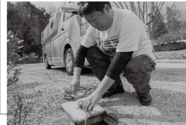
外部電源での充電は、標準設定のコードが届く範囲の電源コンセントで行う。コードリールなどのコード延長はトラブルのもとになる。
