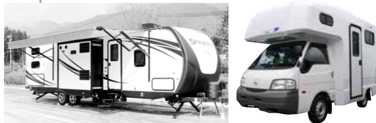
小型のキャブコンやバンコンなら冷房能力ランク2.2kW程度のエアコンで十分。大型トレーラーだと4.0kW程度が必要。この数値は消費電力とは異なるので要注意。
