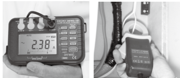
測定はエアコンの電源ラインの一方（AC100Vでは2本線の片方）をクリップメーターの測定部に通して、1分間隔でのデータ集積を行い、最終的には3時間24分までを計測。
