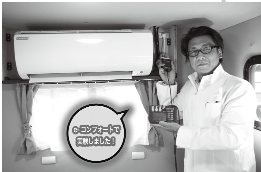
室内機が壁掛け設置式の最新型エアコン「e-コンフォート」で実施。インバーター式の省エネタイプなので、使用電力が少ない機種である。
