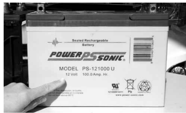
今回撮影したパワーソニック製バッテリーでは、側面に12V、100アンペアであることが明記されていた。
