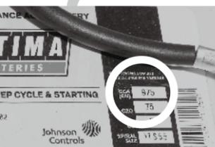
今回の実験で使用したオプティマのイエローシリーズ（ディープサイクルバッテリー）のD1400SはCCA値が975と高いが、20時間率での容量は75Ahと少ない。これを3個並列接続して、合計容量225Ahで実験。
