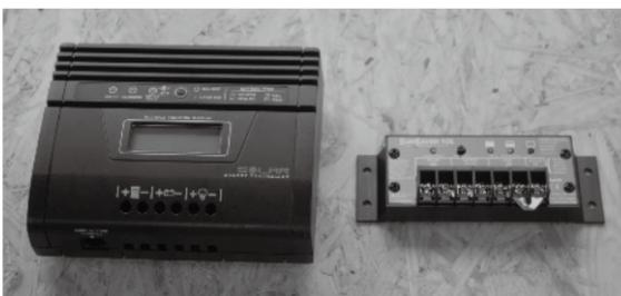
↑ソーラーパネルにシャープ製単結晶タイプの84Wタイプ(小)と198Wタイプ(大)を使用。←ソーラーチャージコントローラーは普及タイプのPWM方式(右)と、高機能で高充電性能を誇るMPPT方式(左)でどのように充電量が違うかを検証実験。
