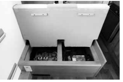
サブバッテリーのDC12VはAC100V(本文参照)に変換する必要がある。それらの機器は多くの場合、シートやベッド下に収納されている。
